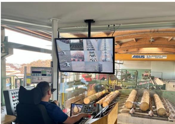
Commend Video Solutions implementierte eine moderne, jederzeit erweiterbare Videoüberwachungsanlage, die über umfangreiche Analyse- und Alarmierungsmöglichkeiten verfügt. Mit den hochqualitativen Kameras von Axis entgeht dem Anwender kein wichtiges Detail und mit den Thermographie-Kameras kann die Temperatur von den Maschinen zuverlässig überwacht werden. Commend hat gemeinsam mit dem Kunden eine sach- und fachgerechte Installation und Inbetriebnahme sichergestellt.
