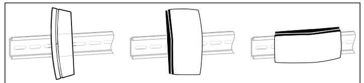
Montagemöglichkeiten mit einem IM3: stehend. Montagemöglichkeiten mit einem IM6: stehend und vertikal liegend.
