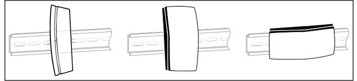
Montagemöglichkeiten mit einem IM3: stehend. Montagemöglichkeiten mit einem IM6: stehend und vertikal liegend.
