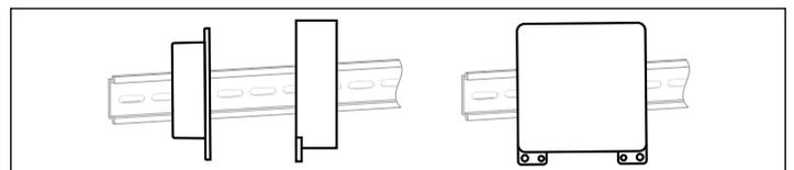
Montagemöglichkeiten mit einer IP-Bridge: vertikal liegend und horizontal liegend.
