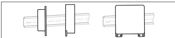
Montagemöglichkeiten mit einer IP-Bridge: vertikal liegend und horizontal liegend.
